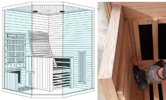
(11) Asamblați suportul de banca și atașați-l cu 2 bucăți de șuruburi de 3,5x25 mm.
